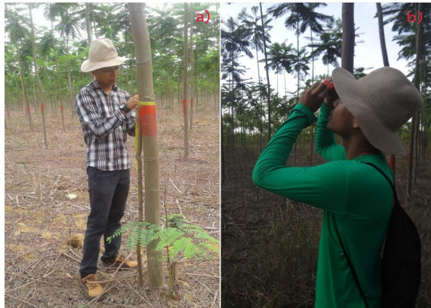
Figure 3 - Segunda medição. a) medição do diâmetro a altura do peito com fita centimétrica; b) medição da altura total com uso do clinômetro eletrônico
