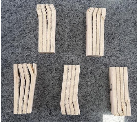
Figura 3 – Modos de ruptura observados nos CPs de compressão paralela às fibras. Fonte: autor (2023).
