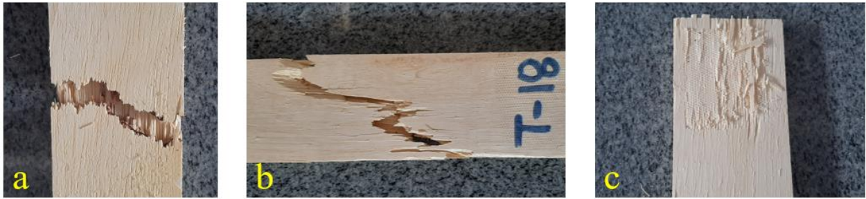
Figura 5 – Modos de ruptura observados nos CPs de tração paralela às fibras. a) corte das fibras, b) tração da madeira, c) esmagamento e cisalhamento das fibras em contato com o mordente. Fonte: autor (2023).
