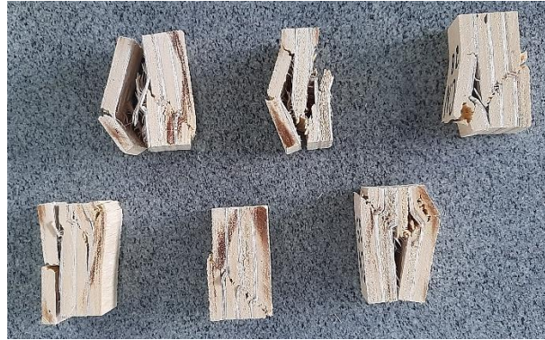
Figura 4 – Modos de ruptura observados nos CPs de compressão perpendicular às fibras. Fonte: autor (2023).
